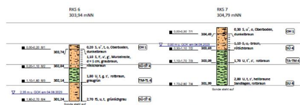
Abbildung 2: Bohrprofil RKS 6 und RKS 7 aus dem 1. Bericht vom 01.09.2023
